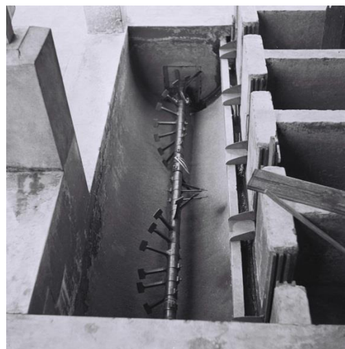
Agitador mecânico destinado a remover restos da mucilagem do café despolpado após a fermentação. Notar os tanques de fermentação do lado direito da fotografia. Fazenda Palestina, de Mario da Silva Cravo. Santa Inês, sudoeste da Bahia, 14 de setembro de 1954.
